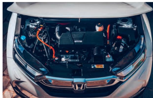
Sinn dahinter: Wenn der Verbrennungsmotor rein als Stromlieferant dient und nichts mit dem direkten Antrieb zu tun hat, dann kann er unabhängig von der Geschwindigkeit und den Fahrständen praktisch immer mit optimaler Leistung laufen – und damit optimal verbrauchsgünstig.
