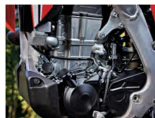
**Rechts:** Der extrem kompakte Antrieb stammt aus dem Motocrosser CRF450R. Die Kunststoffblenden dienen der Geräuschkämpfung.
